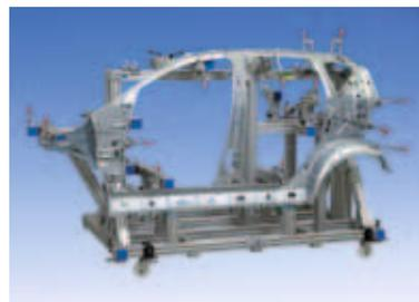
Selbst große Karosserieteile lassen sich auf CARFIT® Vorrichtungen einfach und schnell fixieren und bis auf Hundertstel Millimeter genau vermessen. Ganze Baugruppen wie Pkw-Karosserien werden zur Feinabstimmung in komplizierten „Meisterböcken“ zusammengefügt und überprüft.
